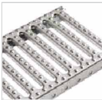
STEP PLUS libisemiskindel pind, üles pressitud ümaraavade ja al- lapoole pressitud piludega.
